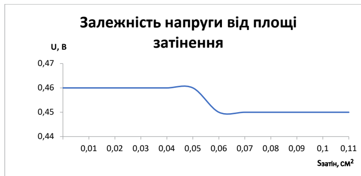
Рис. 4. Залежність напруги від площі затінення
