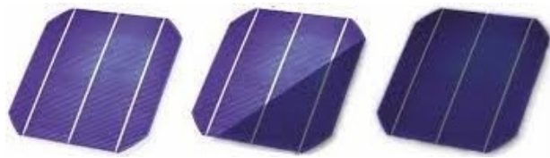
Рис. 1. Приклад затіненого фотоелемента СБ
