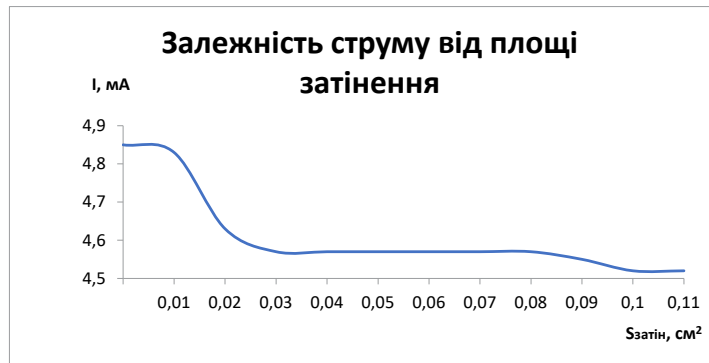
Рис. 3. Залежність струму від площі затінення
