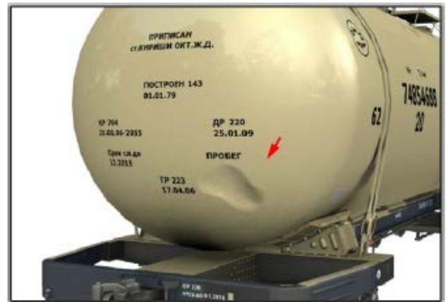
Рис. 3. Пошкодження котла цистерни
