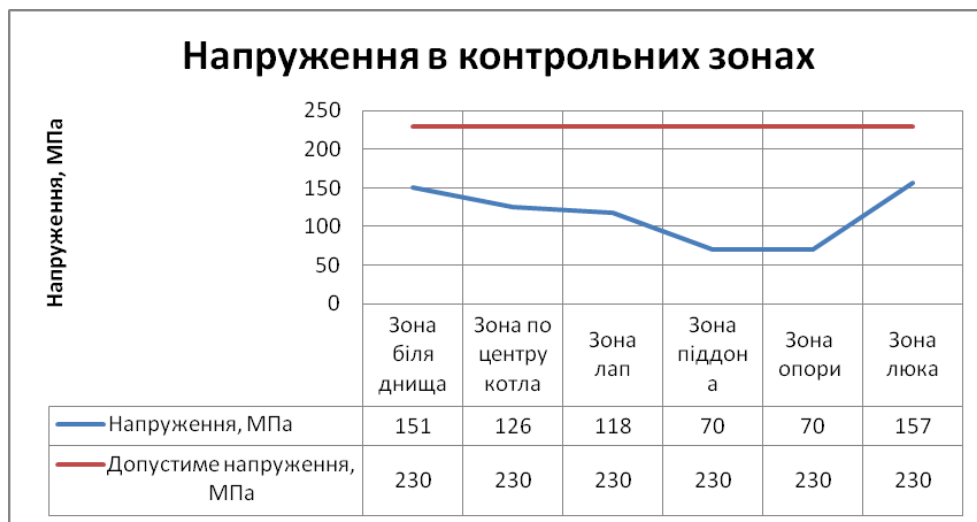
Рис. 9. Графік напружень в контрольних точках під час ударних випробувань
