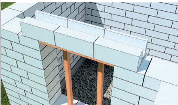
Рис. 2. Загальний вигляд влаштування перемички з використанням лоткового блоку
