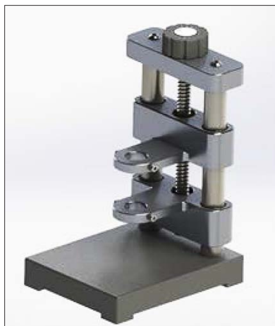
Рис. 3. Внешний вид блока фиксации ультразвуковых преобразователей на поверхности ОК
